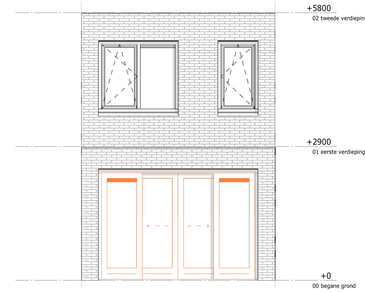
Optie 018A Schuifpui in achtergevel
